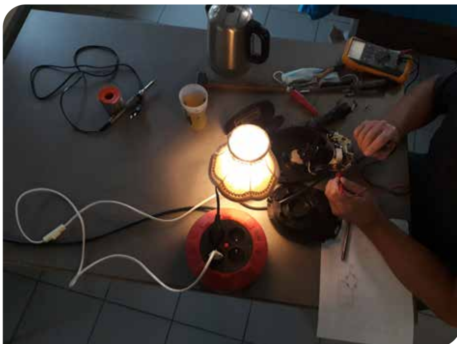
Test au multimètre du circuit électrique d'une bouilloire
